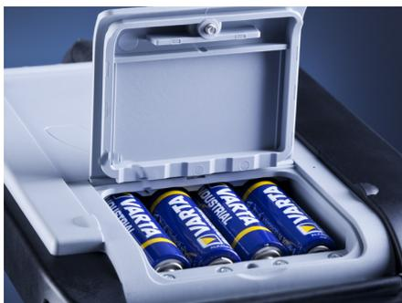
С четырьмя батареями Mignon Portavo может работать более 1000 часов. Открыть отделение для батарей на задней стороне прибора. При установке батарей учтите полярность (см. обозначение в отделении для батарей). Крышку отделения для батарей закройте и от руки заверните.
